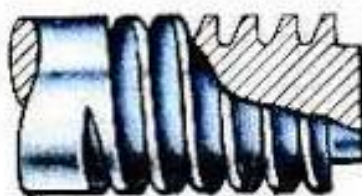
Şəkil 4.3. Dayaq yivinin profili
