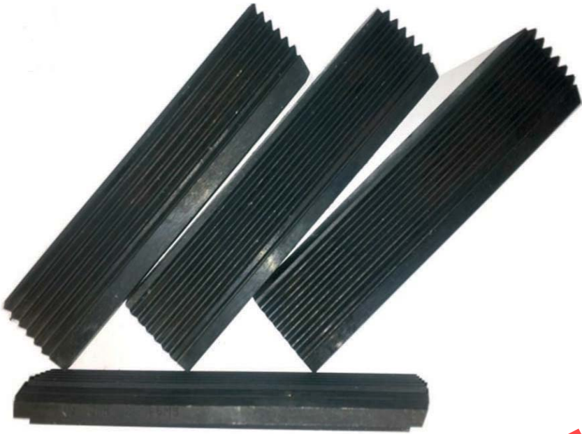
Şəkil 3.29. Yiv daraqları a) yastı mil formada; b) prizmatik; c) dairəvi
