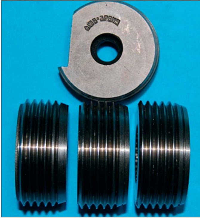
Şəkil 3.30. Yiv daraqlarının ümumi görünüşü
