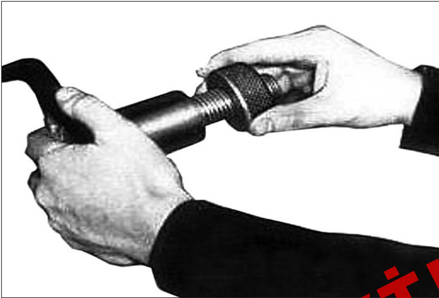
Şəkil 3.37. Açılmış yivin kalibr-halqa ilə yoxlanması
