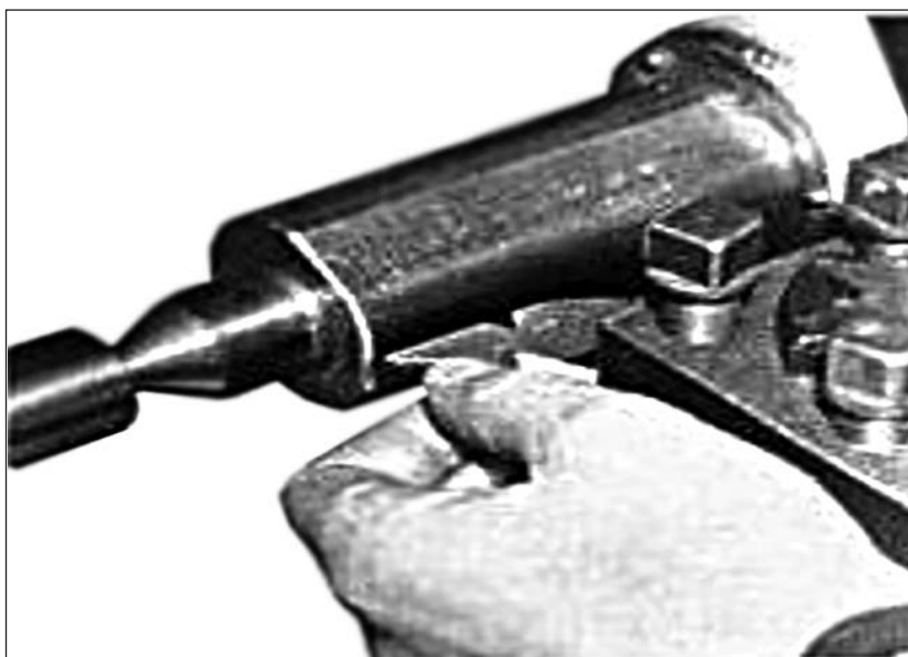
Şəkil 3.28. Xarici yiv açarkən yiv kəskisinin ülgüdən istifadə etməklə qoyulması
