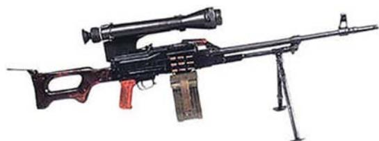
*7,62 мм Модернизированный пулемет Калашникова (ПКМН), оснащенный ночным прицелом типа НСПУ*
