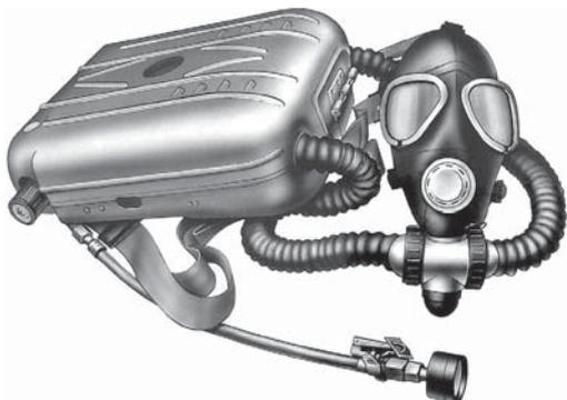
В изолирующих противогазах со сжатым кислородом находящийся в газообразном состоянии кислород содержится под высоким давлением в баллоне (КИП\*-8, КИП-14 и др.). Такой КИП состоит из лицевой части, дыхательной системы и системы передачи кислорода, жесткой задней сумки. В жесткой сумке устройства размещается регенеративный цилиндр,
