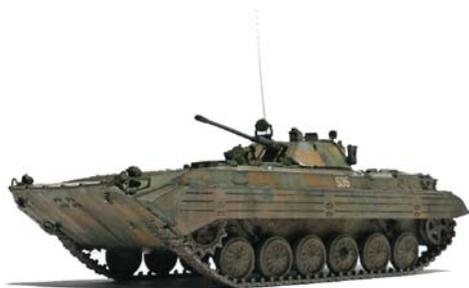
**БМП-2** – предназначение Боевой Машины Пехоты идентично БМП-3. Существуют такие виды как ремонтно-эвакуационная машина БРЭМ-4, броневая машина огнеметов БМО-2, передвижной разведывательный пункт ПРП-4, броневая машина десанта БМД-2 и др. Толщина брони в корпусе и башне – 5–19 мм, в передней части – 23 мм.
