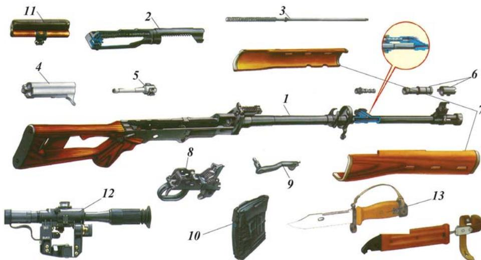
***Снайперская винтовка 7,62 мм типа СВД состоит из следующих частей и механизмов:***
