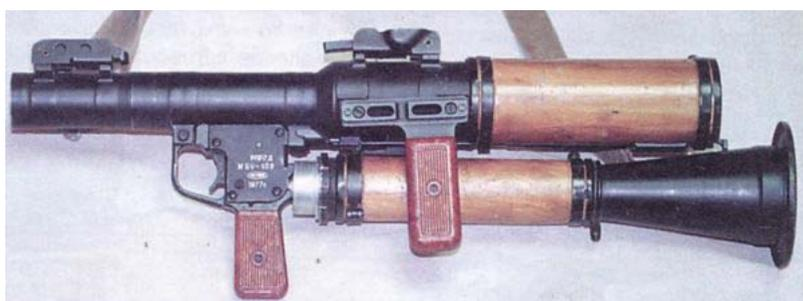
***40 мм-ый противотанковый ручной гранатомет РПГ-7Д***
