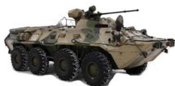
**БТР-80А** – боевая колёсная, плавающая машина, предназначенная для транспортировки мотострелковых подразделений и огневой поддержки в бою. Оснащена 30 мм-ой автоматической пушкой, 7,72 мм-ым пулеметом ПКТ. Боекомплект пушки составляет 300 снарядов, а пулемета – 2000 патронов. Вдвое превышает огневую мощь своего предшественника БТР-80. Масса – 14,4 тонны; экипаж – 3/7 человек; скорость 90 км/час, на воде – 10 км/час; запас хода – 600 км, на воде – 12 часов.
