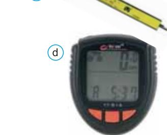
**Odometr** (d) velosiped, motosikl və s. təkərlərinin fırlanması vasitəsilə gedilən yoluñ uzunluğunu ölçən cihazdır.
