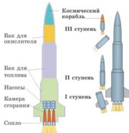
рис.1. Схема ракетоносителя и трехступенчатого ракетоносителя
