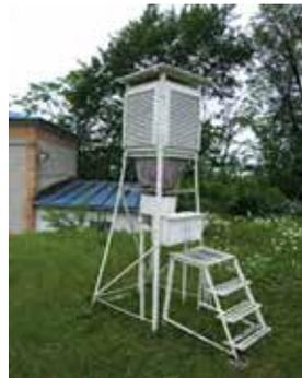
Установка для измерения температуры воздуха
