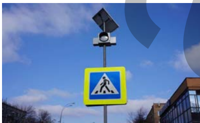
Знак пешеходного перехода, работающий на солнечных батареях. Батареи днем накапливают солнечную энергию, а ночью используют ее.
