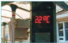
Измерение температуры воздуха электронным термометром
