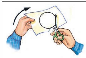
*При вырезании круглых деталей поворачивайте заготовку.*
