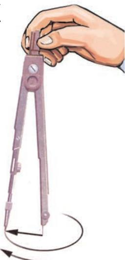
**Рисуется окружность необходимого размера, с помощью линейки и циркуля она делится на части.**
