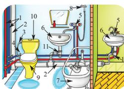
**Рис. 1.** Примерное устройство системы водоснабжения и канализации квартиры
