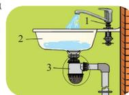
Рис. 1. Устройство умывальника: 1 – смеситель; 2 – раковина; 3 – сифон
