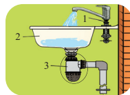
Şəkil 1. Əlüzüyanın quruluşu: 1 – suqarışdırıcı; 2 – çanaq; 3 – sifon
