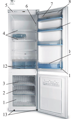
Şəkil 1. Məişət soyuducusu: 1 – dondurucu kameranın tutumu; 2 – aralıq qutu; 3 – üst yəşək; 4 – soyuducu kameranın rəfləri; 5 – temperatur tənzimləyicisi; 6 – soyuducunun işıqlandırma qurğusu; 7 – açıcı qapaqlı saxlama qabı; 8 – çevrilən rəf; 9 – yumurta saxlama rəfi; 10 – rəfayır; 11 – çəpərlı rəf; 12 – meyvə və tərəvəz qabı; 13 – tənzimləyici dayaq.
