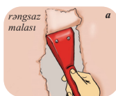
Şəkil 1. Rəngin çıxarılma üsulları: a, b – mexaniki, c – termik
