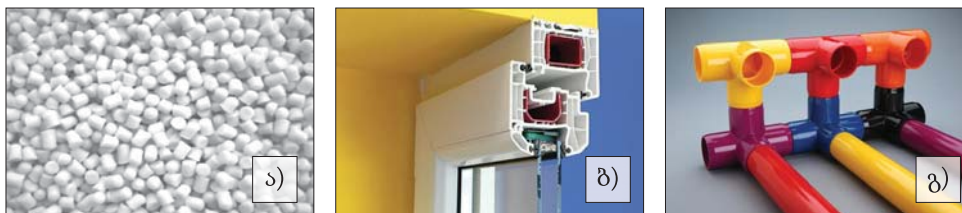
ნახ. 6. ა) პოლივინილქლორიდი (პვქ); ბ) პვქ-დან დამზადებული ფანჯრის ნაჭერი; გ) პვქ-ს მილები
