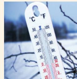
Temperatur, əsasən, dərəcə Selsi ( $^{\circ}\text{C}$ ) ilə, bəzən isə Farengeyt ( $^{\circ}\text{F}$ ) ilə ölçülür. Selsi və Farengeyt temperaturları arasında əlaqə şəkil 1-də təsvir olunmuşdur. Temperaturun bu iki ölçü vahidləri arasında əlaqə vardır: Selsini Farengeytə çeviridikdə:  $F = \frac{9}{5} \cdot C + 32$  düsturundan, Farengeyti Selsiyə çevirdikdə:  $C = \frac{5}{9} \cdot (F - 32)$  düsturundan istifadə edilir.
