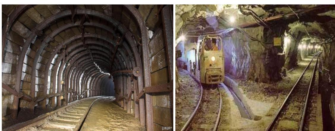
**Ştrek** – faydalı qazıntıının çıkarılması zamanı ştreklər akkumulyasiyalı (faydalı qazıntıının müvəqqəti yiğilması), məişət (doldurucu materialların əldə edilməsi), ventilyasiya (təmizləmə dibindən işlənmiş havanın çıkarılması), əsas (əsas yük yağıımı), nəqliyyat (faydalı qazıntıının çatdırılması) və s. olurlar (Şəkil 4.21,a,b, 4.22).
