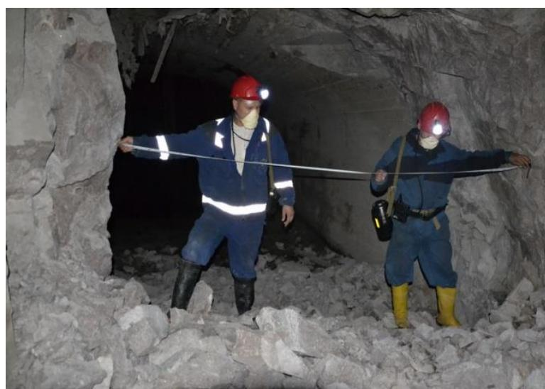
*Şəkil 6.5. Yeraltı dağ qazmasında məsafələrin ölçülməsi*
