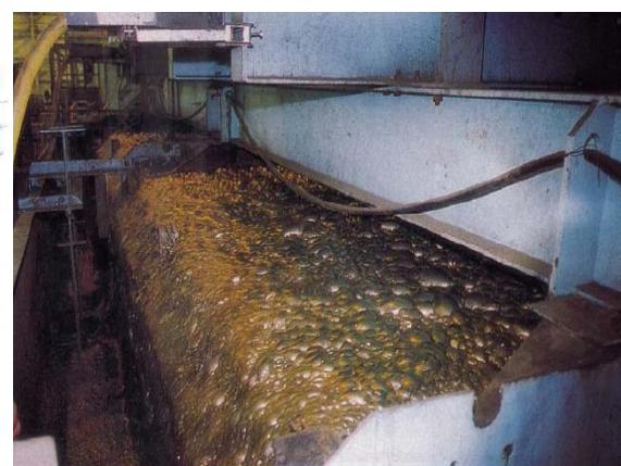
*Şəkil 2.15. Mis-sulfid filizinin sənaye köpüklü flotasiyası*
