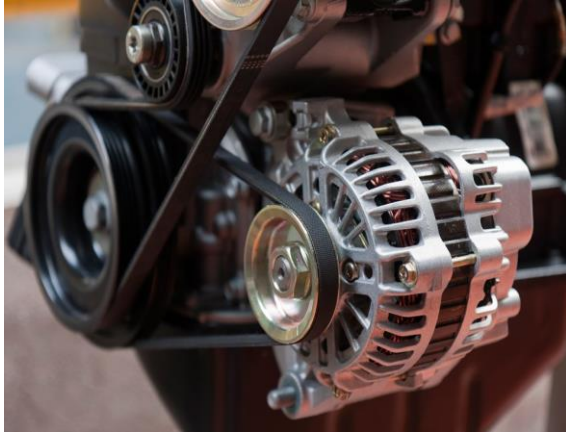
Şəkil 2.9 Generatorun intiqalı (qayış ötürməsi)
