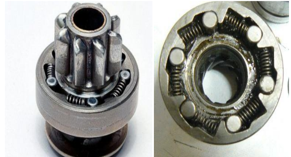
Şəkil 4.13 Starterin intiqal mexanizmi: a – intiqal mexanizminin prinsipial sxemi; b - sərbəst gedişli mufta;
