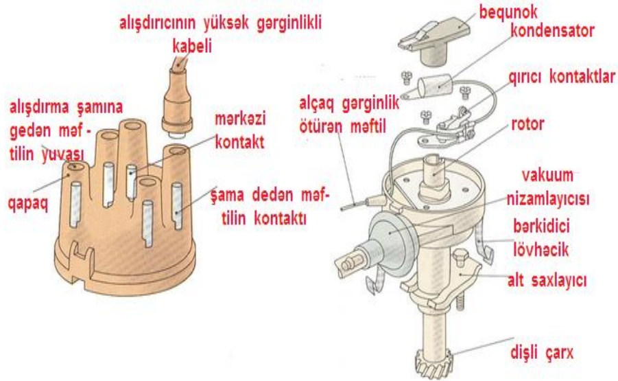
Şəkil 3.3 Qırıcı-paylayıcı
