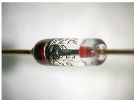
Şəkil 1.10 Kvadrat formalı yarımkeçirici kristal diodun yaxından görünüşü (soldakı qara obyekt)
