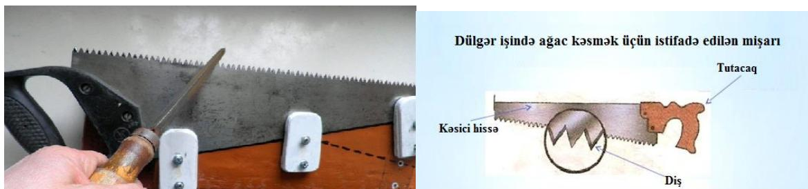
Şəkil 4.14. Əyə vasitəsilə mişarın dişlərinin dibinin itilənməsi
