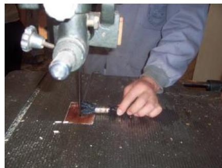
*Şəkil 5.22. Mişarın mazutlu firça ilə təmizlənməsi*
