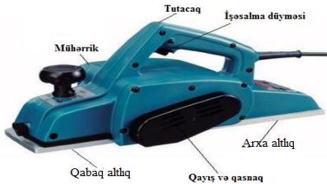
**Şəkil 2.20.** Əl elektrik rəndəsinin konstruktiv elementləri: 1-qabaq tutacaq, 2-qapaq, 3-mühərrik, 4-işəsalma düyməsi, 5-korpus, 6-qayış ötürməsi.
