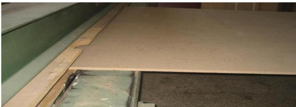
Şəkil 3.8. DSP materialının dəzgahda kobud kəsimi
