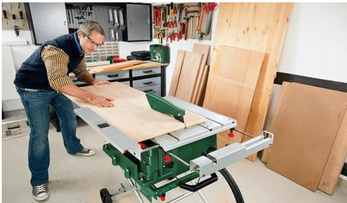
*Şəkil 6.16. Dairəvi mişar dəzgahında materialın kəsilməsi*
