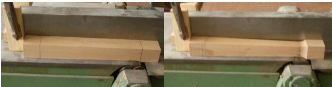
Şəkil 2.24. Parçanın ayaq hissəsinin rəndələnməsi
