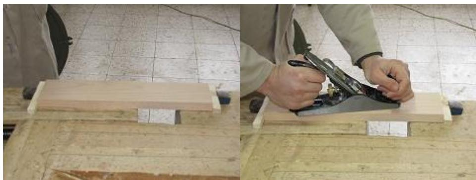
*Şəkil 2.27. Mebel materialının məngənəyə bağlanması və rəndələnməsi*
