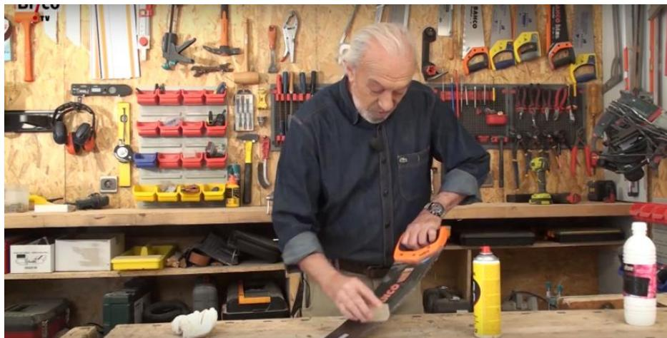
*Şəkil 4.11. Mişarın kəsici hissəsinin parafinlə sürtülməsi*
