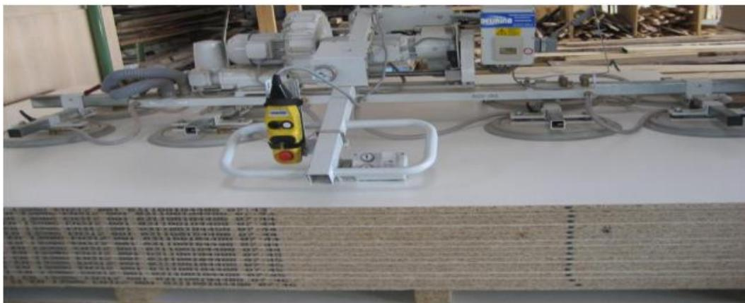
Şəkil 3.9. Lövhələri vakuumlayaraq daşıyan ölçüləndirmə dəzgahı
