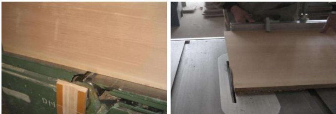
*Səkil 3.11. Örtük çəkilməli mebel materiallarının dəqiq ölçüyə gətirilməsi*
