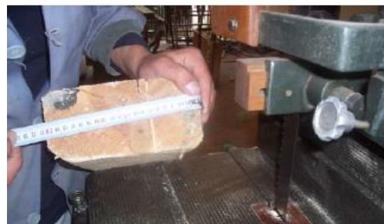
*Şəkil 5.18. Ölçünün yoxlanılması nizamlanması*
