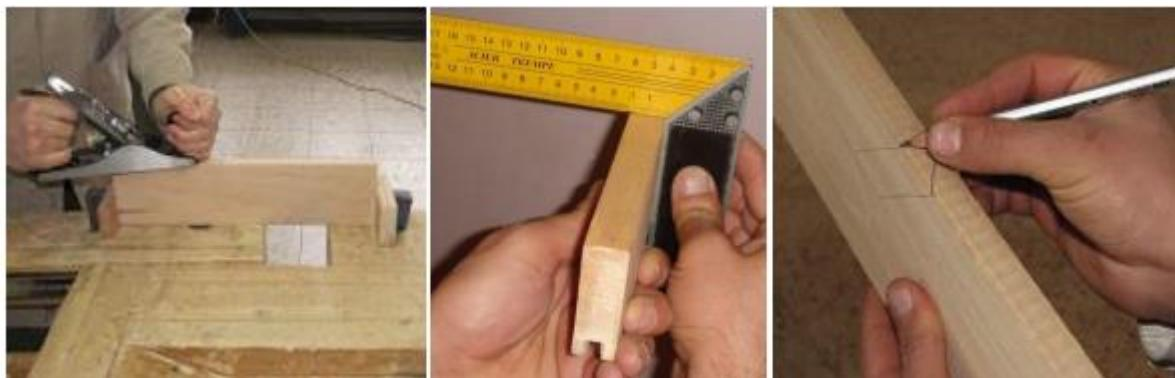
**Şəkil 2.29.** Mebel materialının yan səthinin işarələnməsi, rəndələnməsi və yoxlanılması
