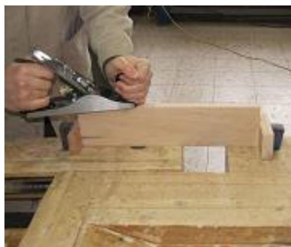
*Şəkil 2.30. Mebel materialının yan hissəsinin rəndələnməsi*
