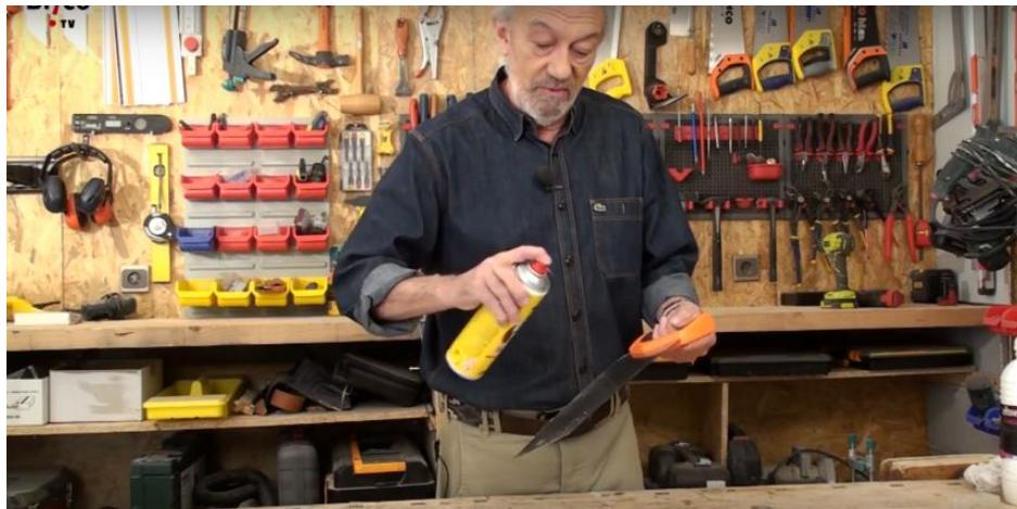
*Şəkil 4.12. Korroziyadan qorunmaq məqsədilə müşara xüsusi dərmanın çilənməsi*
