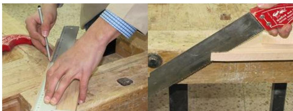
Şəkil 4.19. Nümunənin nişanlanması Şəkil 4.20. Nümunənin uzununa kəsilməsi
