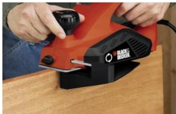
Şəkil 2.25. Əl elektrik rəndəsi ilə səthin kobud rəndələnməsi
