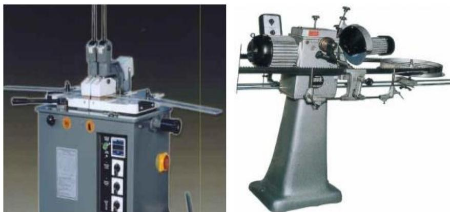
*Şəkil 5.7. Lentvari mişarın qaynaq dəzgahı Şəkil 5.8. Lentvari mişarın itilənmə dəzgahı*
