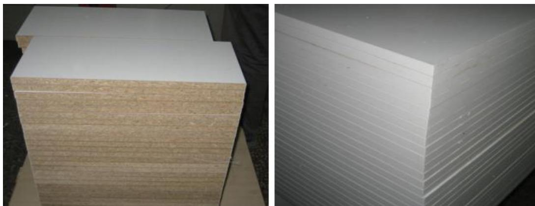
Şəkil 3.10. Dəqiqlik ölçü ilə kəsilmiş və kənarları düzənləndirilmiş mebel materialları
