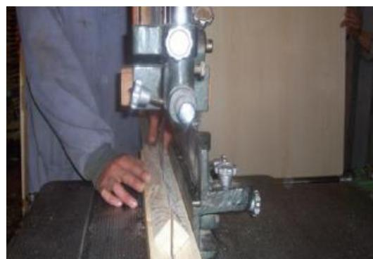
*Şəkil 5.19. Məmulatın diaqonal istiqamətində kəsilməsi*
