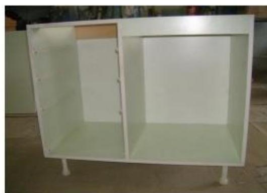
**Şəkil 4.1. Dolab arxalığının bağlılığı çaxmağı ilə montajı və hazır arxalıqlı dolabın görüntüsü**
