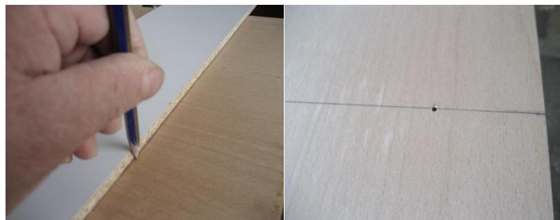
Şəkil 6.10. Dübel yerlərinin işarələnməsi
