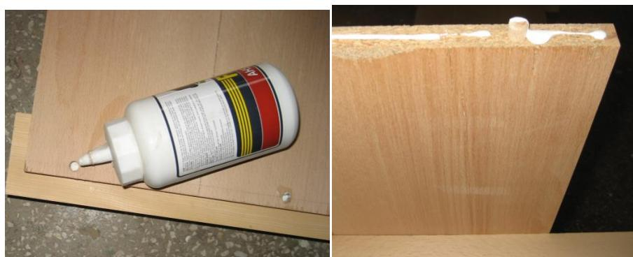
Şəkil 6.14. Lövhələrin birləşdiriləcəyi yerlərə yapışqan sürtülməsi
