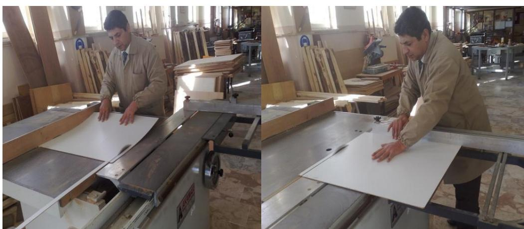
*Şəkil 4.12. Dairəvi mişar dəzgahında arxalığın kəsilməsi*
