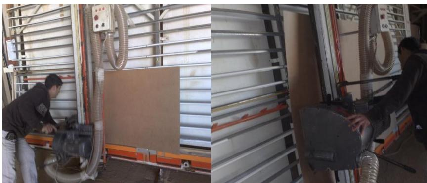
*Şəkil 4.11. Şaquli ölçmə maşınında arxalığın kəsilməsi*
