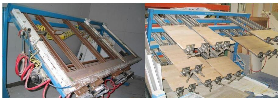
Şəkil 6.23. Lövhə montaj presləri
