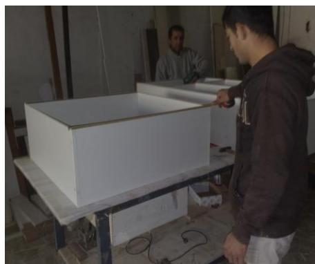
Şəkil 4.10. Arxalıq ölçüsünün alınması
