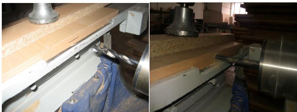
*Şəkil 6.12. Üfüqi deşik açma dəzgahında dübel deşiklərinin açılması*
