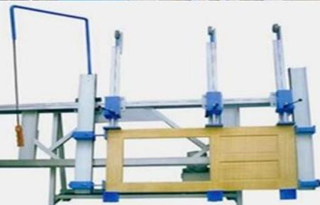
*Şəkil 6.19. Doğrama montaj presləri*
