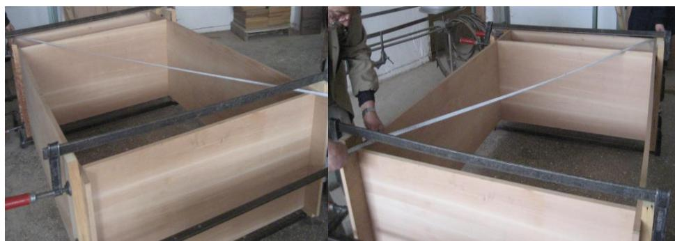
*Şəkil 6.17. Birləşdirilən hissənin günüə yoxlanılmasının yerinə yetirilməsi*
