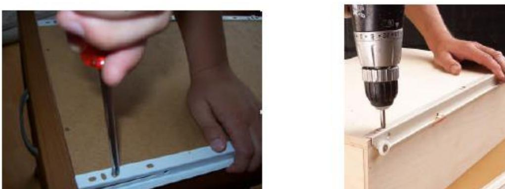
*Şəkil 4.22. Ray sisteminin siyirmə qutusuna montajı*
