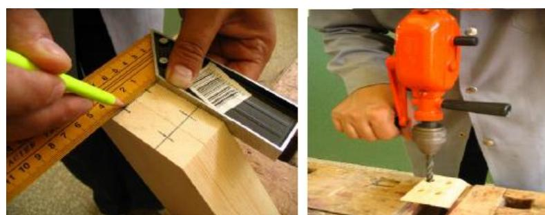
*Şəkil 2.31. Dəliklərin mərkəzlərinin qeyd olunması və dəliklərin açılması*
