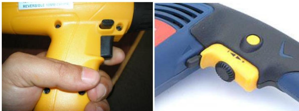
*Şəkil 2.19. Sürəti tənzimləmə düyməsi*
