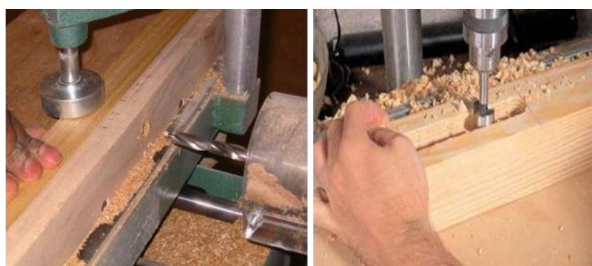
*Şəkil 2.33. Burğulama dəzgahlarında mebel elementinin tillərində deşiyin və ya oyuğun açılması*
