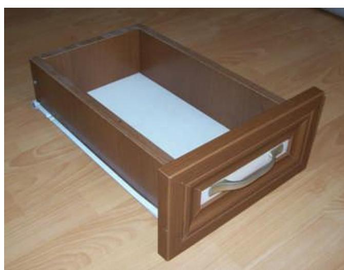
*Şəkil 4.21. Rayları bağlanmış siyirmə qutusu*
