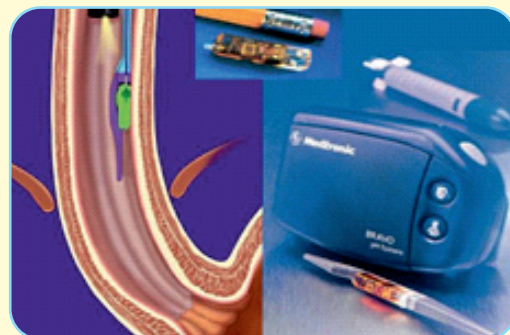
рН-радиокапсула "Браво" измеряет кислотность
