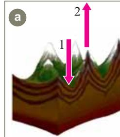
**Qırışıq dağlar.** Süxur laylarının çökən hissəsi – **sinklinal** (1), qalxan hissəsi – **antiklinal** (2) adlanır.
