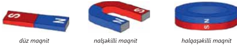
Şəkil 4. Müxtəlif formalı maqnitlər
