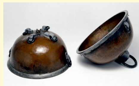
Atmosfer təzyiqini nümayiş etdirmək üçün istifadə olunan Maqdeburq yarımkürələri
