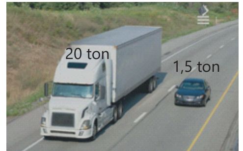
Şəkil 4. Bərabər sürətli avtomobillərdən kütləsi böyük olanın kinetik enerjisi daha böyükdür.
