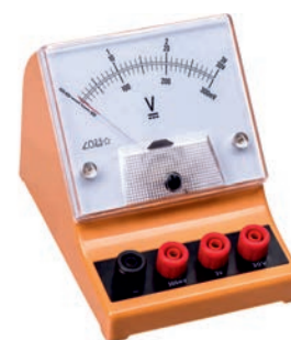
Voltmetr: gərginliyi ölçən cihaz – qövsvari şkala
