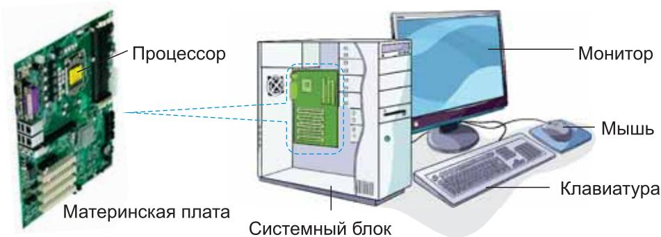
Небольшой по размеру процессор (площадью приблизительно 2 см<sup>2</sup>) управляет работой всех устройств компьютера.
