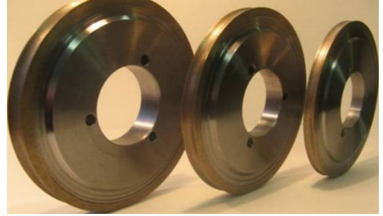
Şəkil 2.22. Bərk cilalayıcı dairələr
