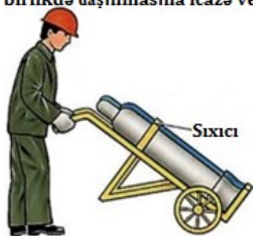
Xüsusi resorlu və rezin təkərli araba ilə daşınması
