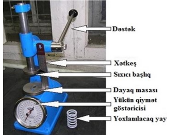
Şəkil 1.13. Klapan yayının elastikliyinin yoxlanması
