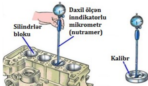
Şəkil 1.5. Silindrin daxili diametrinin ölçülməsi
