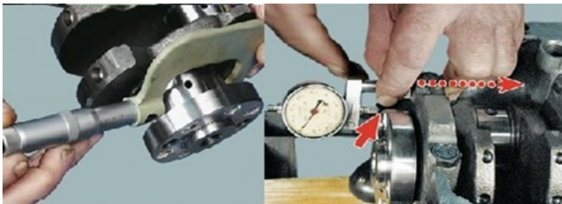
Şəkil 1.8. Dirsəkli valın yoxlanması
