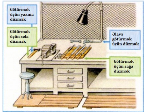
Şəkil 6.2. İşçi yerində alətlərin saxlanması və rahat istifadəsi üçün avadanlıq. İşçinin ayaq altına taxta ayaqaltı qoyulur
