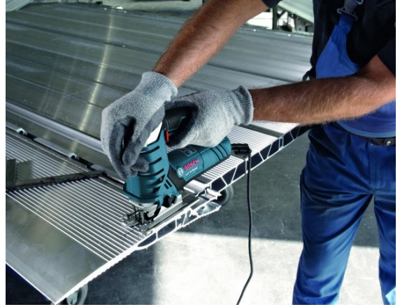
Şəkil 4.31. Elektrolobzıqla metalın kəsilməsi
