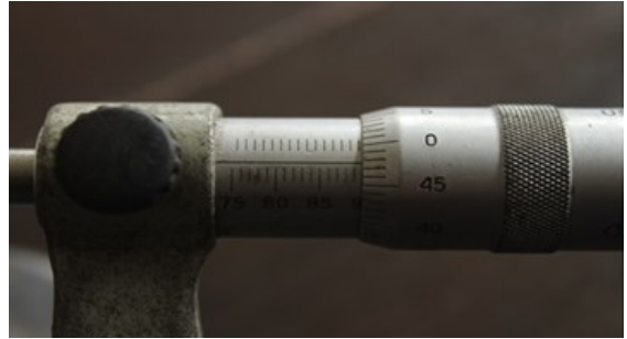
Şəkil 1.24. Mikrometrlə ölçmə
