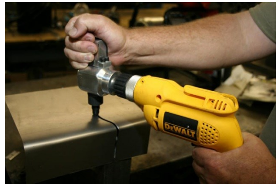
Şəkil 4.33. Metalların drellə kəsilməsi
