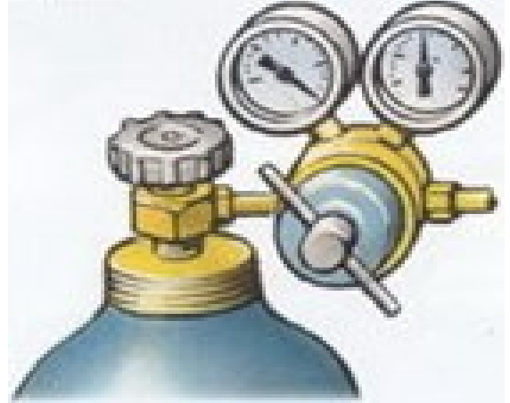
Şəkil 3.18. Balondan verilən qazın təzyiqinin nizamlanması
