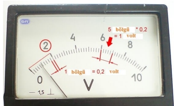
Şəkil 4.49. Voltmetrin bölgüləri üzrə ölçmənin hesablanması
