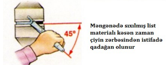
Şəkil 6.45. İşin növündən asılı olaraq zərbələrdən istifadə
