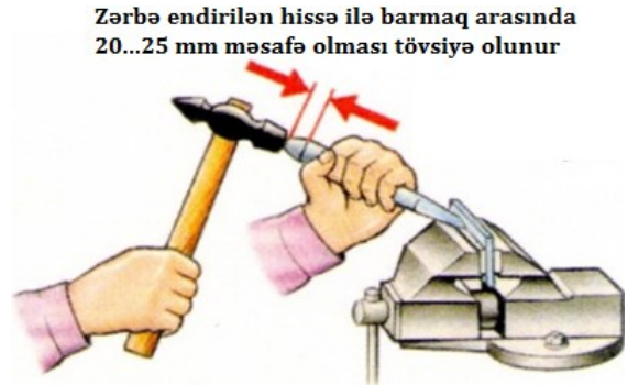
Şəkil 6.46. Məngənədə sıxılmış hissənin zubulla təhlükəsiz kəsilməsi
