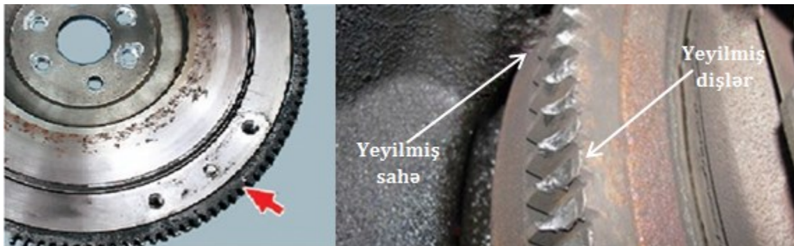
Şəkil 1.9. Nazim çarxın yoxlanılması
