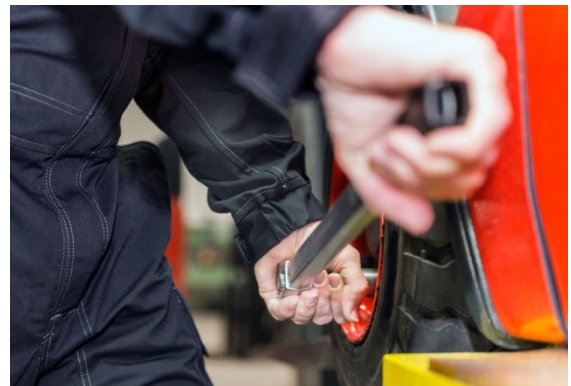
Şəkil 4.51. Dinamometrik açarlardan istifadə olunması
