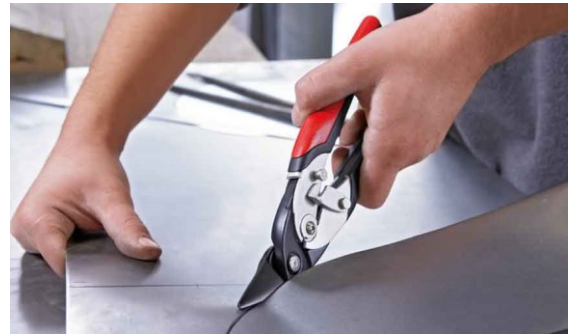
Şəkil 4.25. Əl qayçısı ilə nazik metal listin kəsilməsi
