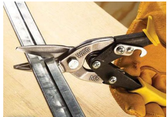
Şəkil 4.22. Metalların qayçı ilə kəsilməsi
