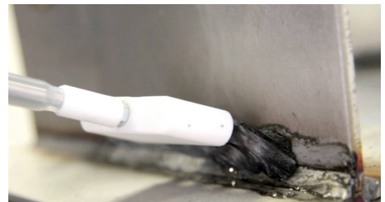
Şəkil 6.36. Qaynaq yerini təmizləmək üçün fırça
