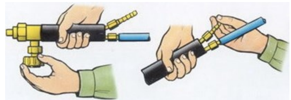
Şəkil 3.16. Qazqarışdırıcının asetilen borusunun işə hazırlığının yoxlanılması
