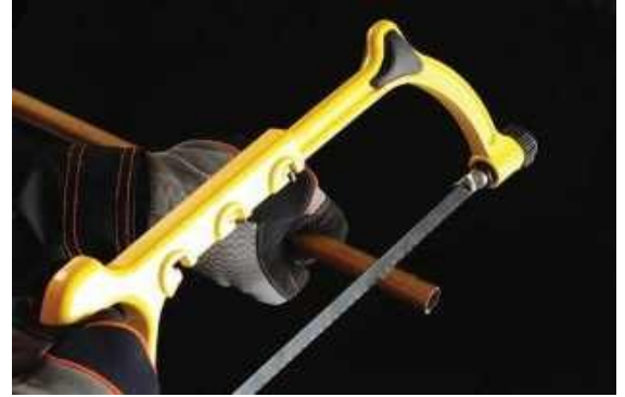
Şəkil 4.29. Metal borunun bıçqı ilə kəsilməsi
