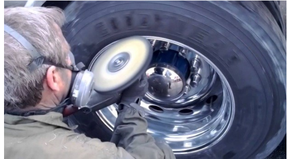
Şəkil 2.38. Pardaqlama işi
