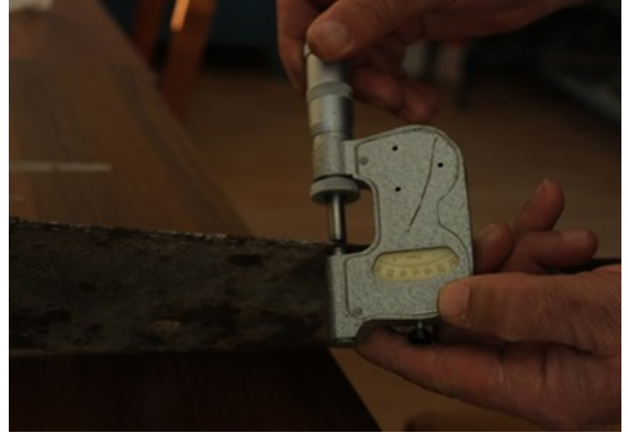
Şəkil 1.21. Gavahının yeyilməyə yoxlanılması
