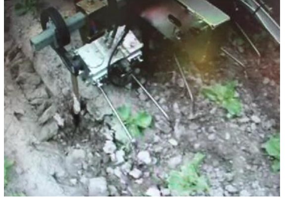
Şəkil 4.7. Müasir kultivatorla bitkinin kök boğazına yaxın hissəsinin yumşaldılması və əlaqların məhv edilməsi
