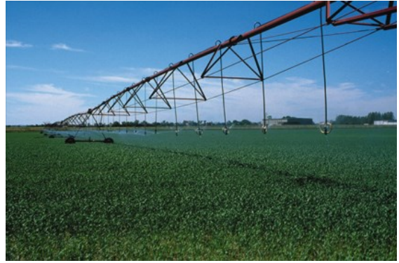
Şəkil 4.22. Pambıq tarlasında süni yağışyağdırma qurğusu
