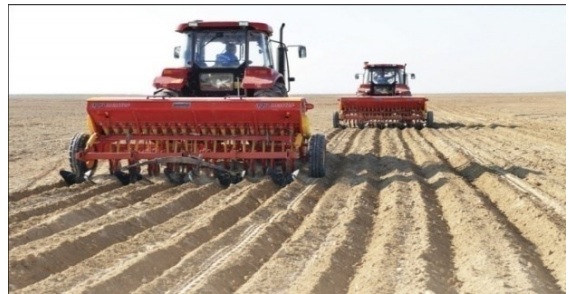
Şəkil 3.16. Tirə üsulu ilə səpin. Türkiyə istehsalı olan “Öztekin” markalı toxumsəpənlə səpilməsi
