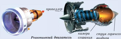
Как самолёт движется на небе? Чтобы найти ответ на этот вопрос, ознакомимся с работой реактивного двигателя. Большой пропеллер в передней части этого двигателя всасывает воздух. Далее происходит скжатие воздуха, который нагревается за счет горения топлива в камере сгорания. В результате воздух расширяется. Нагретая струя воздуха выталкивается из задней части двигателя и способствует продвижению самолёта вперед.
