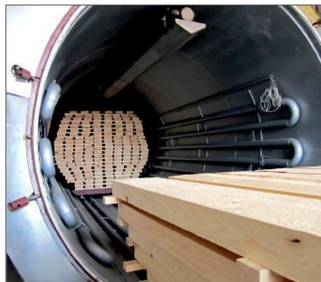
*Рис. 2. Сушка пиломатериалов в сушильной камере*
