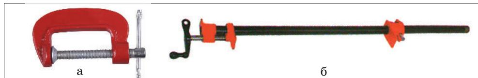
*Рис. 6. Зажимы: а) – G-образный зажим (струбцина); б) – винтовой зажим*
