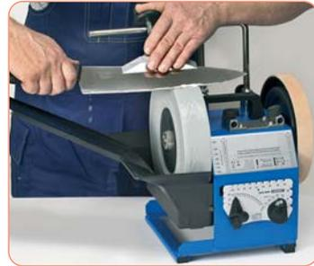
**Рис. 2.** Заточка ножа на электрическом точильном станке
