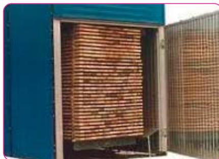
*Рис. 2. Сушка пиломатериалов в сушильной камере*
