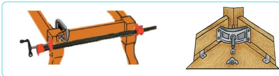
**Рис. 7.** Склеивание треснувшего гнезда
