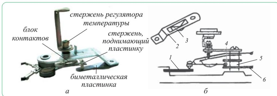
Рис. 3. а – терморегулятор; б – схема регулирования температуры
