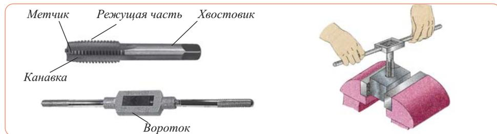
Рис. 7. Нарезание внутренней резьбы метчиком
