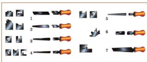
Şəkil 1. En kəsiyinin formasına görə yeyələrin növləri və onların təbii nümunələri: 1–yastı; 2–yarım dairəvi; 3–kvadrat; 4–üçüzlü; 5–dairəvi; 6–rombşəkili; 7–bıçaqşəkili
