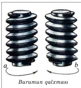
*Şəkil 4. Burumlarının istiqamətinə görə yivlərin növləri: a — sağ yiv, b — sol yiv*
