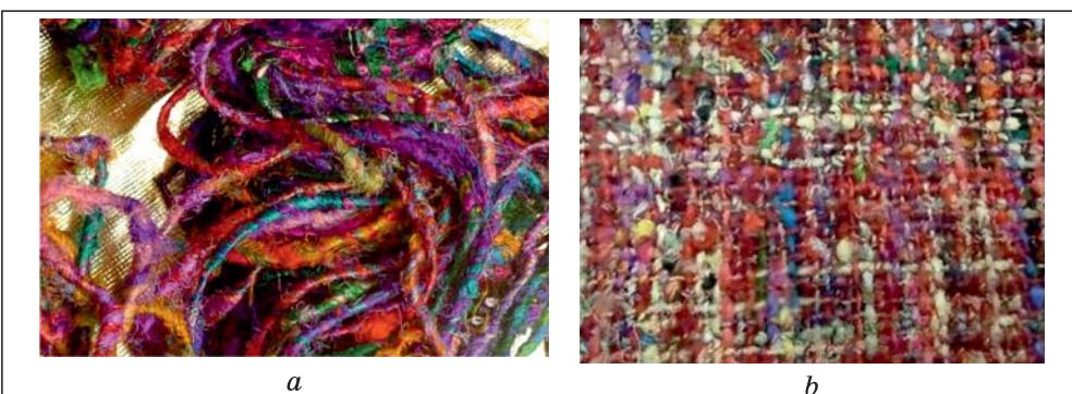
*Şəkil 2. a — asetat lifi; b — asetat lifdən parça*
