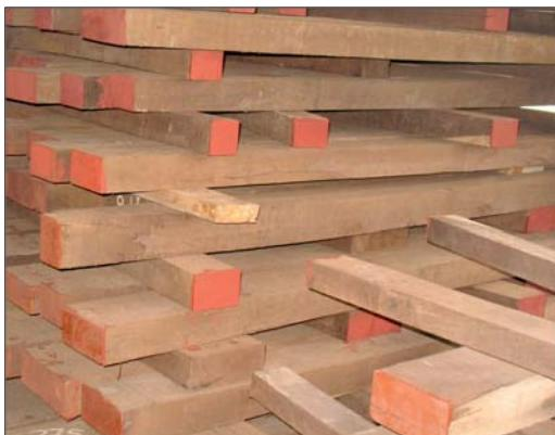
*Şəkil 1. Mişar materiallarının qalaq şəklində qurudulması*
