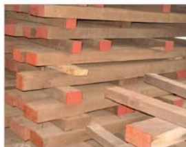
Şəkil 1. Mişar materiallarının qalaq şəklində qurudulması
