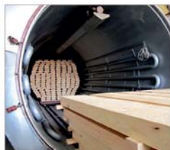
Şəkil 2. Mişar materiallarının qurutma kamerasında qurudulması
