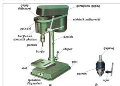
Şəkil 1. a — HC-12 markalı burğu dəzgahının quruluşu; b — burğu patronu
