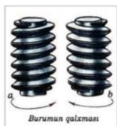
Şəkil 4. Burumlarının istiqamətinə görə yivlərin növləri: a – sağ yiv, b – sol yiv
