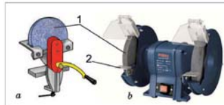
Şəkil 1. a—əl itiləmə dəzgahı; b—elektrik itiləmə dəzgahı; 1—bülöv daşı; 2—dayaq
