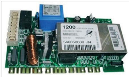
*Şəkil 5. Elektron idarəetmə bloku*
