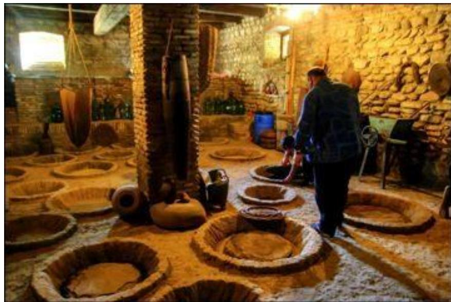
*Şəkil 2.7. Zirzəmidə şərab istehsalında istifadə edilən əzintinin qıcqırılmasının yeraltı tutumları*
