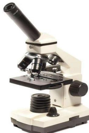
*Şəkil 3.3. Laboratoriya mikroskopu*
