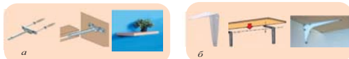
Рис. 1. Способы крепления с помощью специальных креплений: а – невидимый (внутренний штырь), б – видимый (кронштейн**) Видимый способ крепления выполняют с помощью различного вида кронштейнов, металлических стоек, подвесок и т. п (рис.2).
