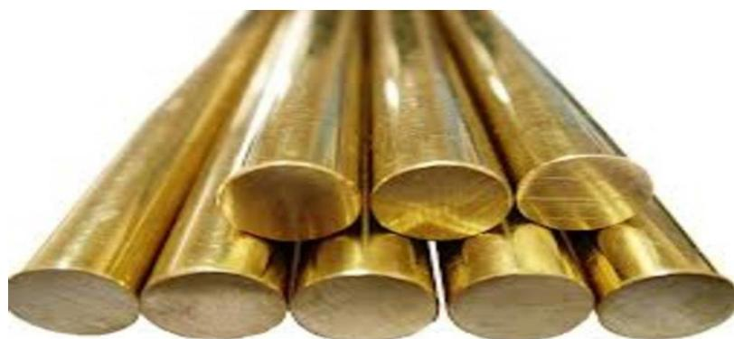
*Şəkil 1.11. Büründən hazırlanmış çubuqlar*
