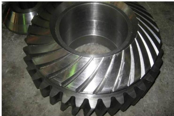
*Şəkil 1.3. Keyfiyyətli karbonlu poladdan hazırlanmış dişli çarx*
