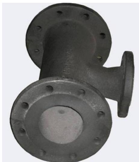
*Şəkil 1.5. Sadə karbonlu çuqundan hazırlanmış detal*
