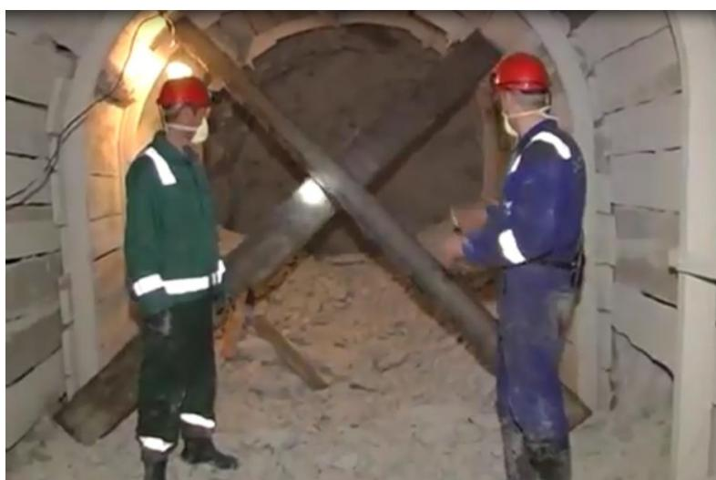
*Şəkil 2.26. İmtina etmiş PM atımı olan qazma dibinin çəpərlənməsi*
