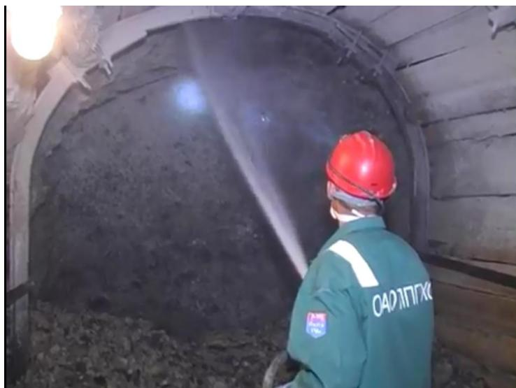
*Şəkil 2.23. Növbəti partlayışa hazırlıq üçün dibin su ilə yuyulması*
