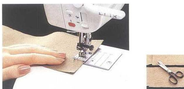
*Şəkil 3.31. Bortun üst hissə ilə künclər və çərtiklər üst-üstə düşmək şərtilə birləşdirilməsi*
