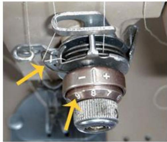
*Şəkil 1.19. Üst sapın çox sıxlaması*
