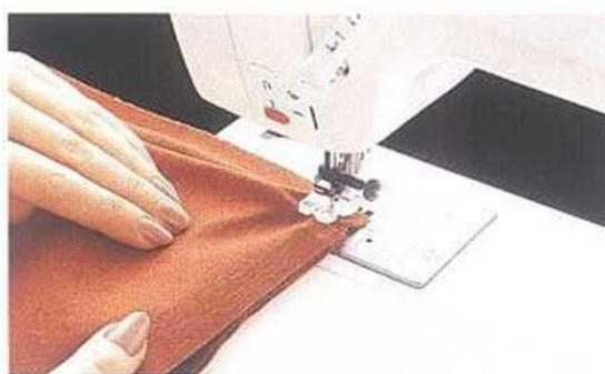
*Şəkil 3.26. Hissənin küncü ilə borta vurulmuş çərtlərin üst-üstə yerləşdirilərək tikilməsi*
