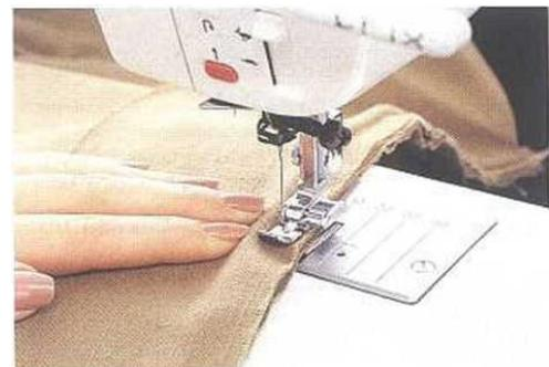
*Şəkil 3.30. Bort kəsiklərinin birləşdirilməsi*
